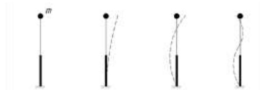
Рис.4 Розрахункова схема і три власних форми коливань
