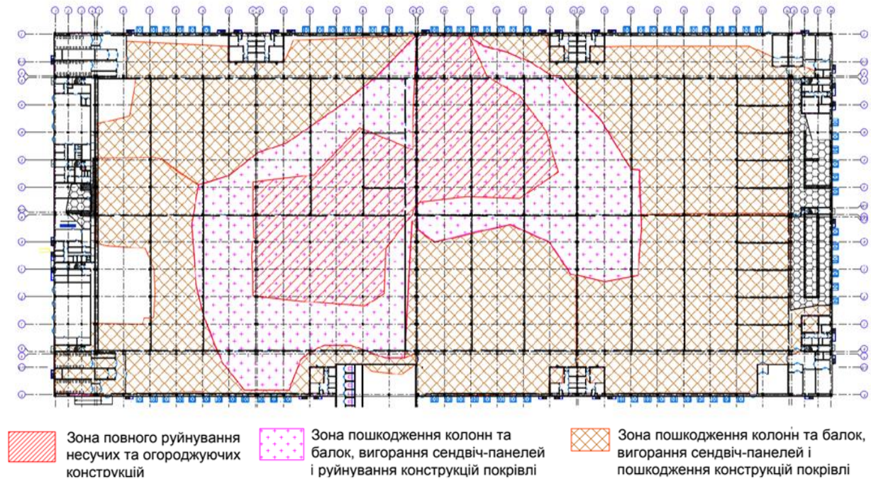
Рис. 7. Схема руйнувань Fig.7. Map of the damaged areas
