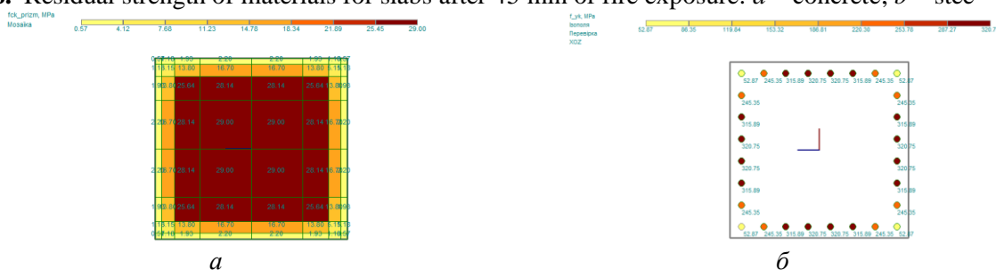
Рис.9. Зниження міцності матеріалів колон після 120 хв вогневого впливу: а) бетон; б) арматура
