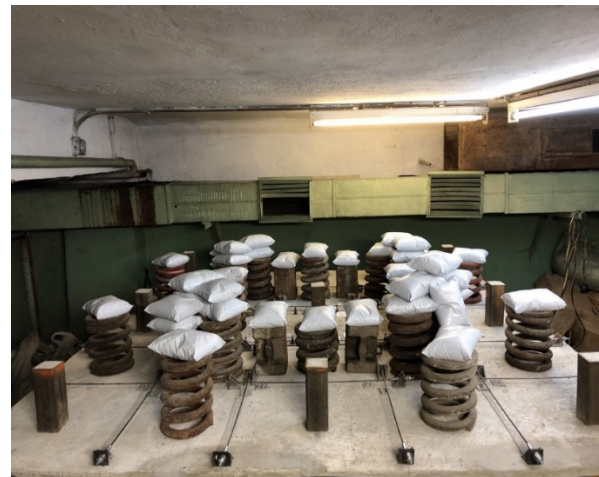
Рис.6. Завантаження експериментальної моделі. 2 етап – сумарне навантаження 581 кг.
