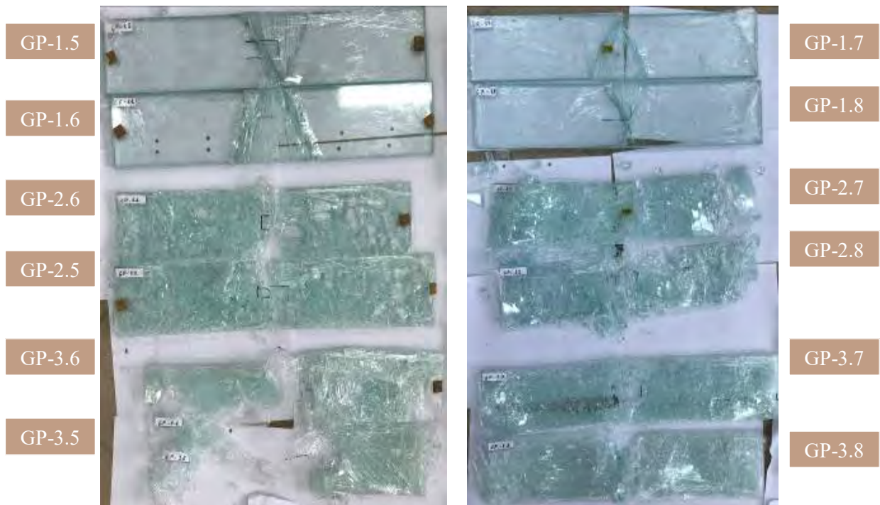
Рис.8. Вигляд дослідних зразків після руйнування. Fig.8. Type of prototypes after destruction.
