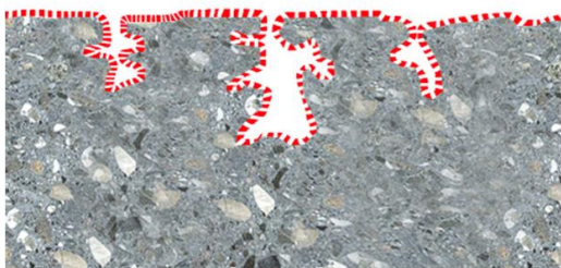
Рис. 4. Схематичний рисунок гідрофобної імпрегнації
