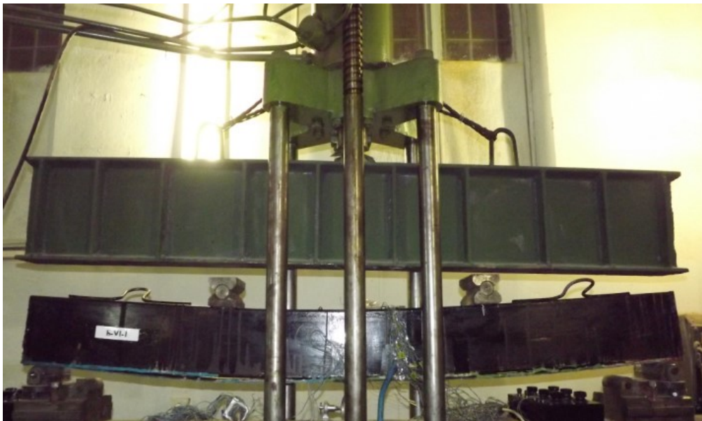
Рис.2. Типова картина прогину та розтріскування сталезалізобетонної балки, підсиленою сталеву пластиную
